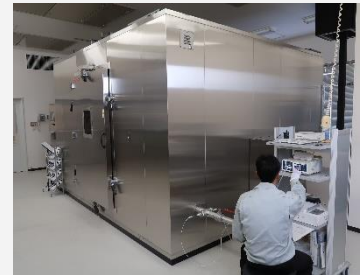
北陸最大級の揮発性有機化合物（VOC）等 放散測定大形チャンバーシステム
